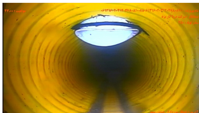
شماره تصویر ۶ عنوان اتصال جانبی معيوب / اتصال معيوب انشعاب موقعیت ۲۷۰۰ کد CX
