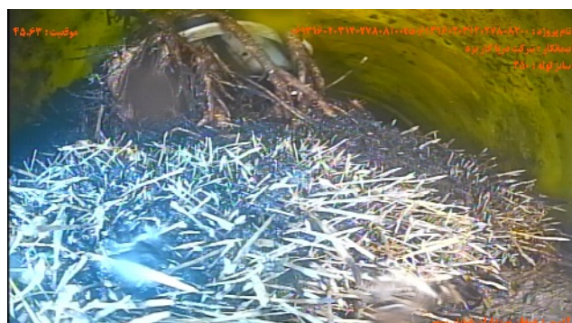
شماره تصویر ۱۰ موقعیت ۴۵.۶۳ کد RM عنوان نفوذ ریشه/نفوذ انبوه ریشه ها و کاهش سطح مقطع به میزان % درصد ۷۰
